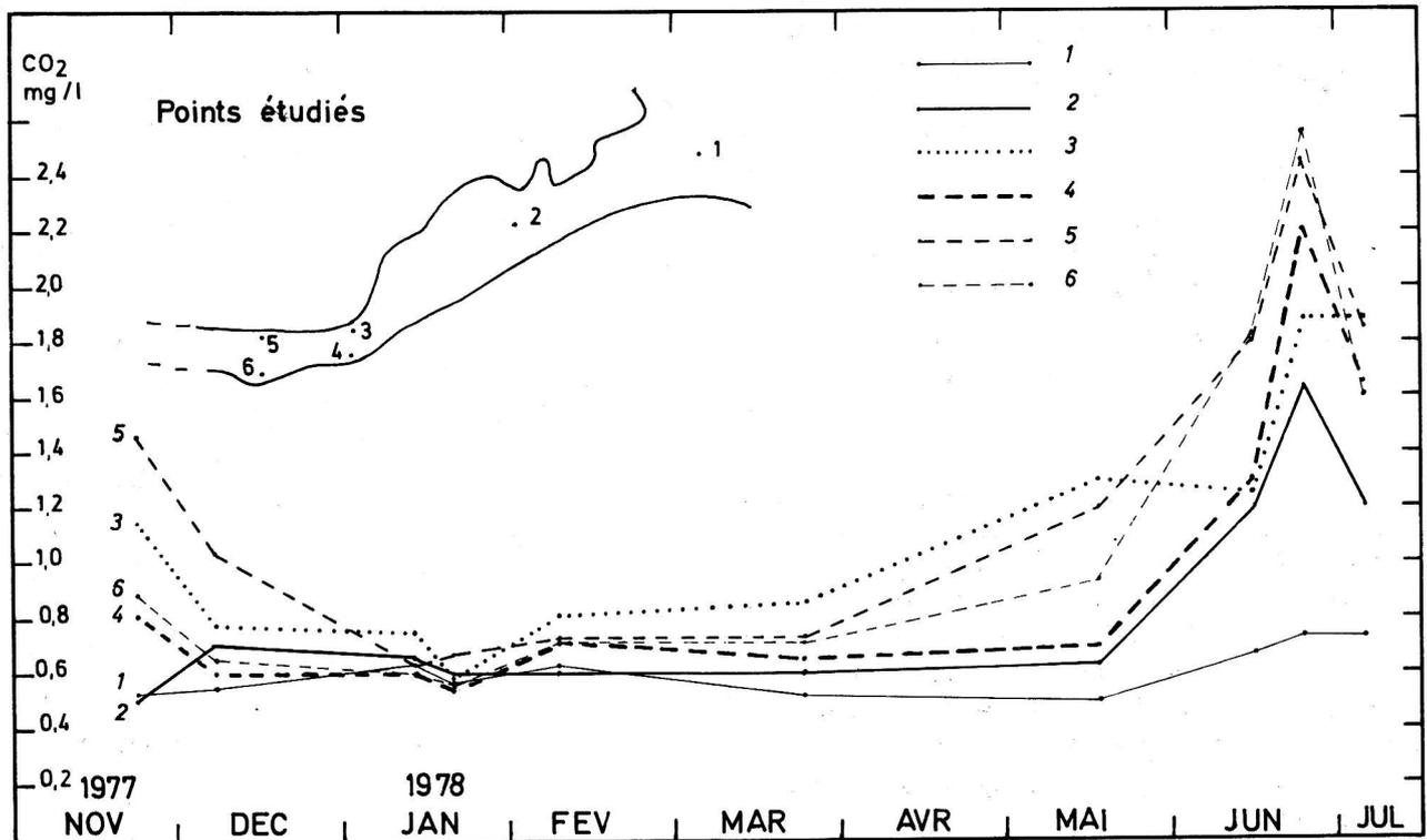
Figure 13.- Le Trou Joney. Variations de la teneur en CO<sub>2</sub> de l'air aux six points de prélèvement les plus proches de l'entrée de la grotte. Le point 1 est à l'extérieur de la grotte.
