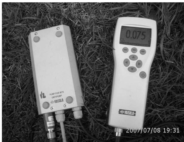
**Figure 2** Le Vaisala. A gauche, la pompe. A droite, le senseur-enregistreur.
