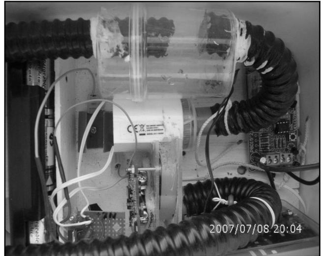
**Figure 4** Data-logger en circuit fermé (do it yourself, Omega). Photo du senseur et du data-logger.Omega).
